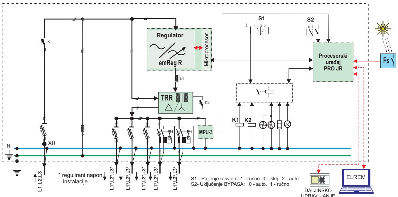
Razdjelnik regulacije vanjske i unutarnje rasvjete ELREM PRO-RRx opremljen trofaznim električnim regulatorom emReg-R 3x400V i dodatnim transformatorom TRRn 400/42V je realiziran kao samostojeći ormari za uklop ,regulaciju i razvod instalacije javne rasvjete sa priključcima za 1-6 razvodnih kabela za napajanje standardnih izvora s plinom punjenim žaruljama-metalhalogene(HQI) i visokotlačni natrij(HPS,NaH).Razdjelnik se izrađuje prema projektu.
